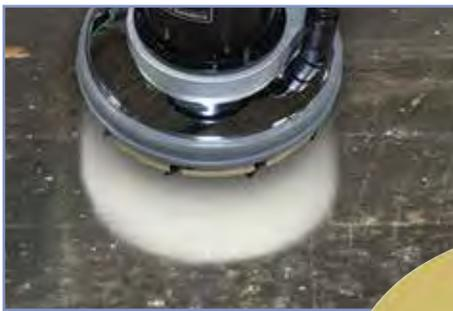
La herramienta de remoción de recubrimiento de **Diamabrush®** by **Malish®** está diseñada para *remover recubrimientos difíciles del concreto* como son pinturas, uretano, adhesivo para alfombras, pegamento para azulejos, etc.
